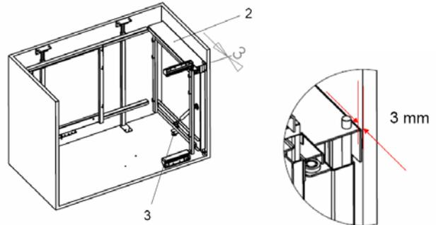
Fissare il perno fine corsa (4) e il manovellismo (5) rispettando le quote riportate in figura e permettendo l'inserimento della rotella (3) nella guida del manovellismo (5)
