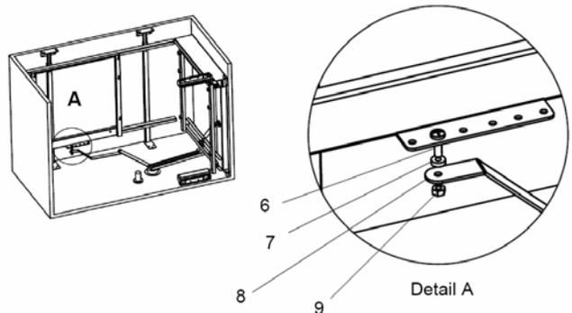
Montare lo sportello (posizione dei fori riportate in figura) e le coperture in plastica dei frontalini (10). Appendere i cesti piccoli (11) sul telaio laterale ed i cesti grandi (12) sul telaio posteriore
