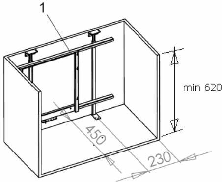
Fissare il telaio laterale (2) rispettando le quote indicate in figura
